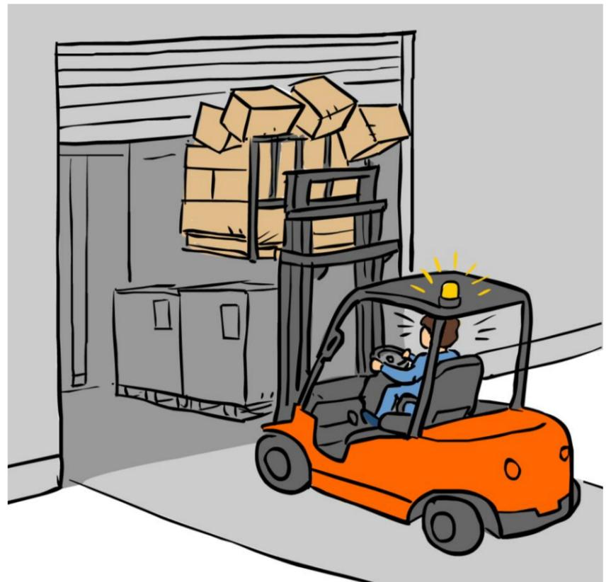
3. No circules con la carga levantada.
