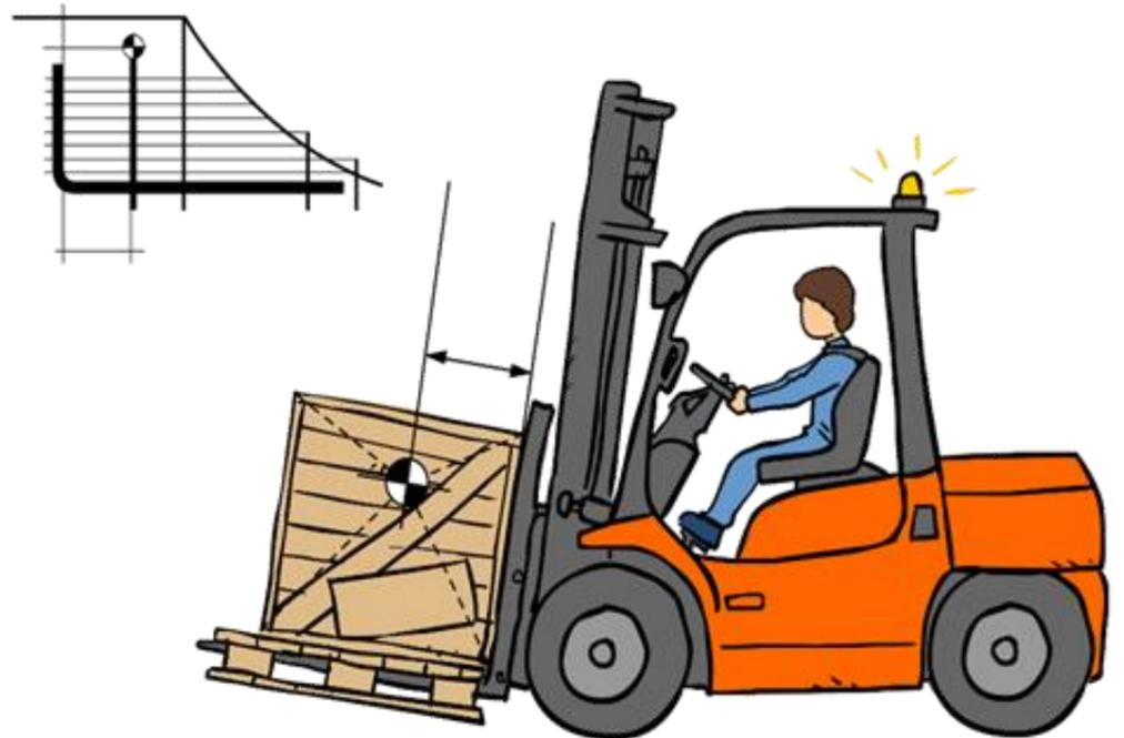
2. Circula siempre con las horquillas en posición baja y a una distancia de 15-25 cm del suelo.
